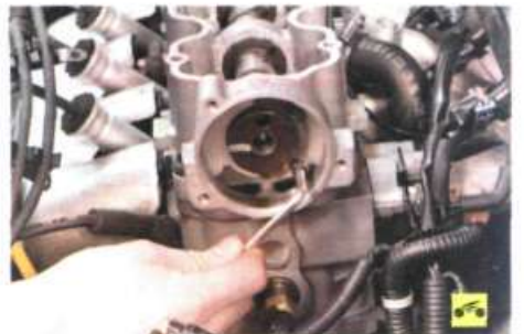
8. Ослабьте затяжку двух болтов крепления упорного фланца распределительного вала.
