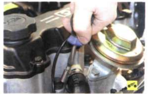
5. Ослабьте хомут крепления подводящего шланга системы вентиляции картера двигателя...
