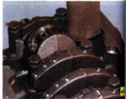
23. Нажмите деревянным бруском (рукояткой молотка) на шатун...
