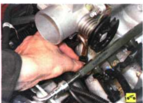
9. ...и снимите шланг с патрубка дроссельного узла.
