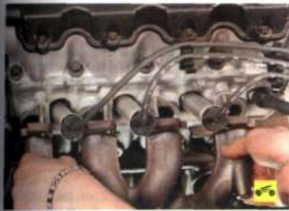
3. Снимите со шпилек выпускной коллектор...
