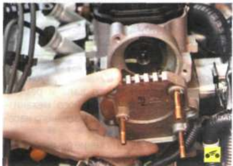
4. ...и снимите кронштейн.
