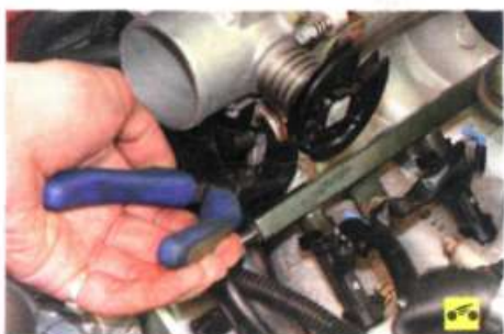
8. Ослабьте хомут крепления шланга подвода охлаждающей жидкости, сжав пассатижами его отогнутые ушки, сдвиньте хомут по шлангу...
