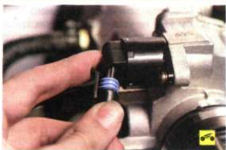
3. Отсоедините колодки моторного жгута проводов от регулятора холостого хода...
