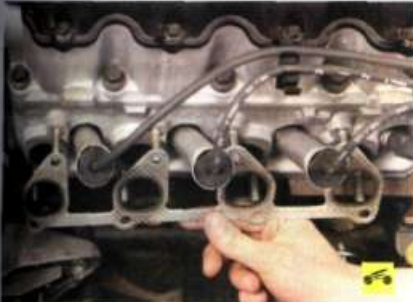
4. ...и установленную под ним прокладку. 5. Тщательно очистите привалочные поверхности головки блока и выпускного коллектора от остатков старой прокладки и нагара.
