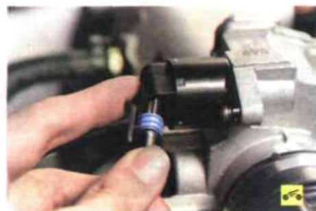
22. Отсоедините колодки моторного жгута проводов от регулятора холостого хода...
