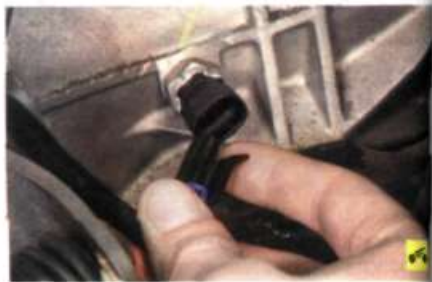
30. ...и выключателя света заднего хода.
