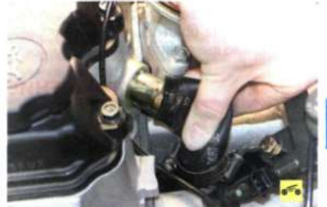
6. ...и отсоедините шланг от патрубка корпуса распределительного вала.
