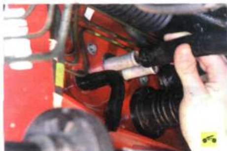
20. ...и отсоедините шланги отопителя от патрубков радиатора отопителя на щите передка кузова.
