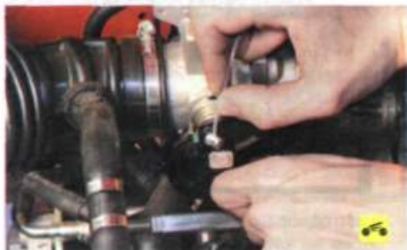
27. Отсоедините от сектора дроссельного узла наконечник троса привода дроссельной заслонки...
