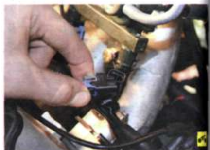
32. Отсоедините колодки жгута проводов от форсунок и отведите жгут форсунок в сторону.
