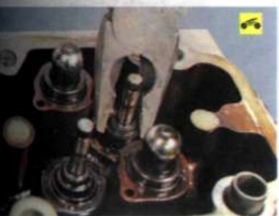
8. Снимите пассатижами с направляющей втулки клапана маслоотъемный колпачок.
