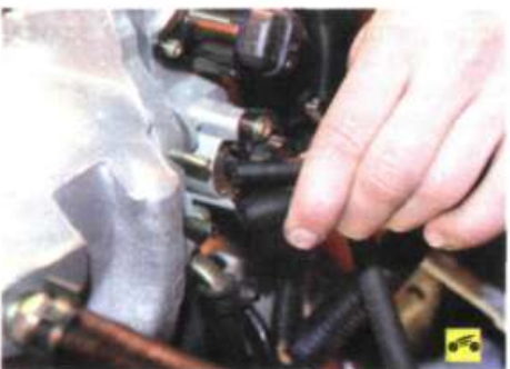
6. Отсоедините от впускной трубы шланг малой ветви системы вентиляции картера двигателя.
