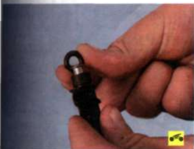
3. Отсоедините колодки моторного жгута проводов от регулятора холостого хода...
