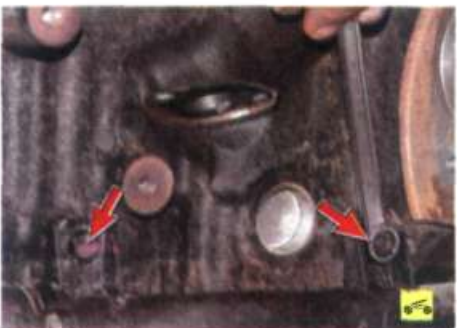
16. ...и снимите патрубок и установленную под ним прокладку.
