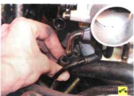
10. Аналогично отсоедините шланг слива охлаждающей жидкости.
