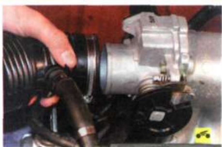
7. Ослабив хомут крепления, отсоедините воздухоподводящий рукав от патрубка дроссельного узла и отведите рукав в сторону.
