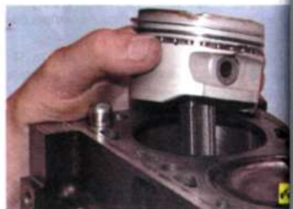
23. Нажмите деревянным бруском (рукояткой молотка) на шатун...
