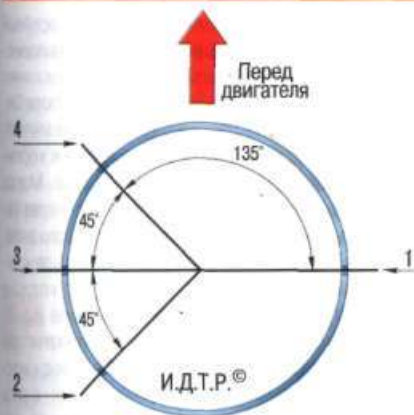
Рис. 5.13. Расположение замков поршневых колец перед установкой поршня в цилиндр: 1 – расширителя маслосъемного кольца и верхнего компрессионного кольца; 2 – верхнего кольца составного маслосъемного кольца; 3 – нижнего компрессионного кольца; 4 – нижнего кольца составного маслосъемного кольца
