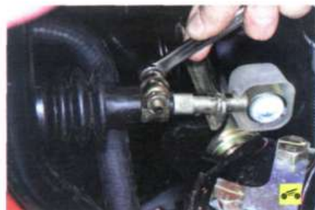
21. Ослабьте затяжку болта клеммового зажима привода управления механизмом переключения передач и разъедините тягу и наконечник рычага переключения передач.
