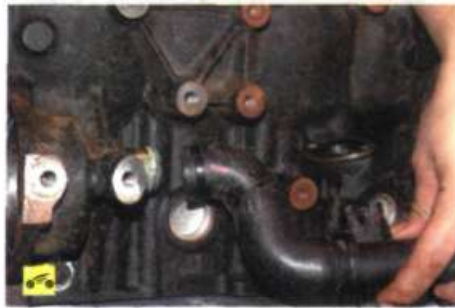
19. ...и снимите водораспределительную трубу.
