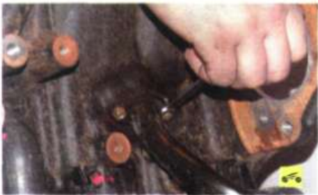
15. Выверните два болта крепления патрубка системы вентиляции картера...
