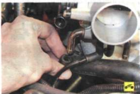
25. ...шланги подачи и слива охлаждающей жидкости...
