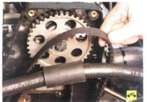
9. Ослабьте натяжение и снимите ремень привода газораспределительного механизма с зубчатого шкива распределительного вала (см. «Замена и регулировка натяжения ремня привода газораспределительного механизма и замена его натяжного ролика», с. 64).
