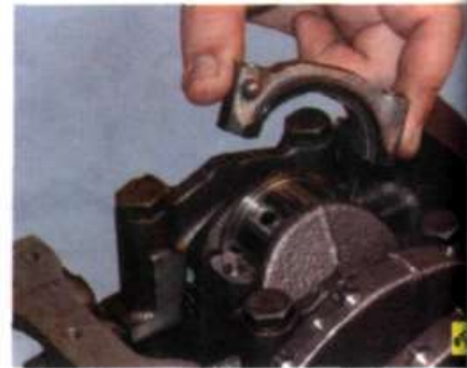
22. ...и снимите крышку с вкладышем.
