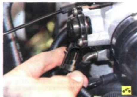
22. Отсоедините колодки моторного жгута проводов от регулятора холостого хода...
