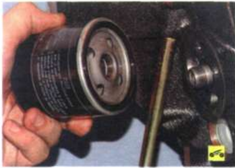
13. ...и масляный фильтр (см. «Замена масла в двигателе и масляного фильтра», с. 48).
