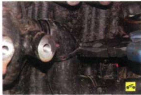
18. ...ослабьте хомут крепления шланга трубы к патрубку блока цилиндров...
