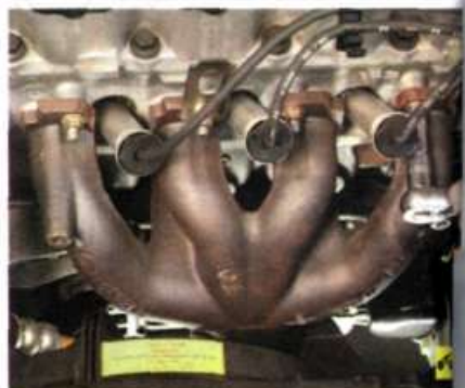
Рис. 5.6. Последовательность отворачивания гаек крепления выпускного коллектора
