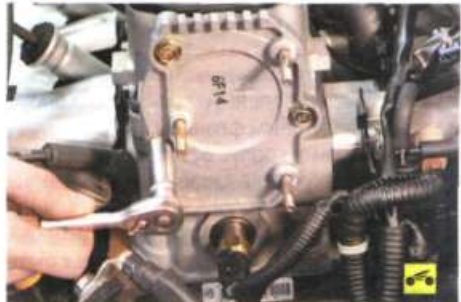
3. Выверните три болта крепления кронштейна катушки зажигания к корпусу распределительного вала...
