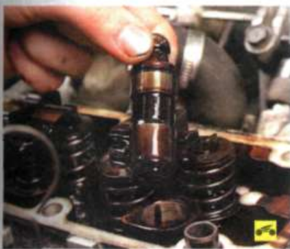
3. Извлеките из гнезда головки блока гидрокомпенсатор.
