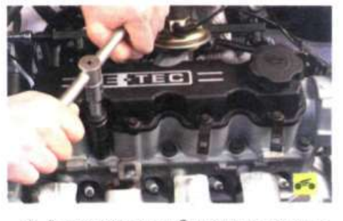
Рис. 5.4. Последовательность затяжки болтов крепления головки блока цилиндров
